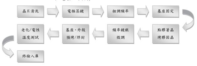
後製程-(振盪器與石英晶體相比,多IC 放置與打線製程)
